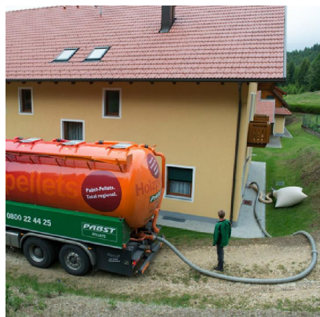
Abbildung 4. 3: Lose Zustellung der Pellets mittels Pelletspumpwagen (Obernberger, 2009)
